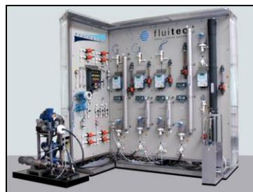
栓流反応器(プラグフロー反応器)
